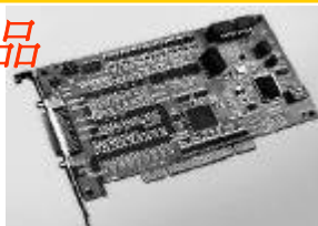
PCI-1220U PCI 2 轴步进/脉冲 型伺服电机控制卡
