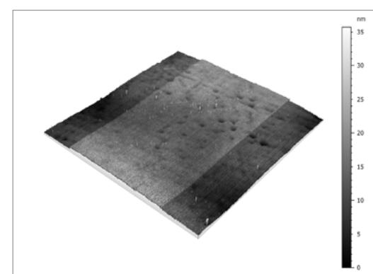
8 nm 台阶高度标样、高度图，C Epiplan-Apochromat
