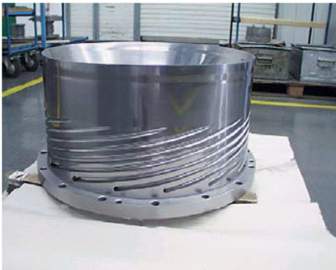
图 8 离子氮化、抛光及 CrN 多层镀层螺旋分频器，用于箔加工
