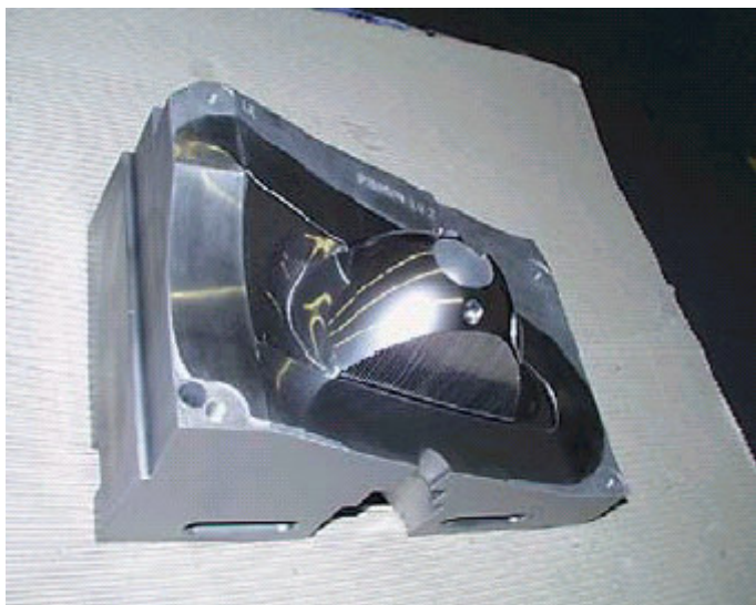
图 3 用于加工反射体的模具，经过离子氮化、CrN 镀层和抛光处理。
