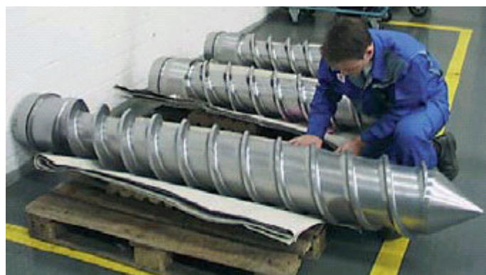
图 6 采用离子氮化和 PVD CrN 多层镀层的蜗杆，用于 PVC 挤压加工
