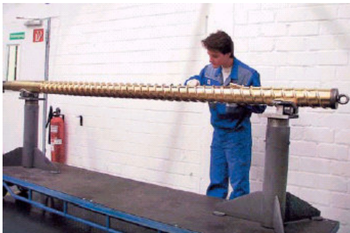
图 9 TiN 镀层螺杆,用于 PC 注塑
