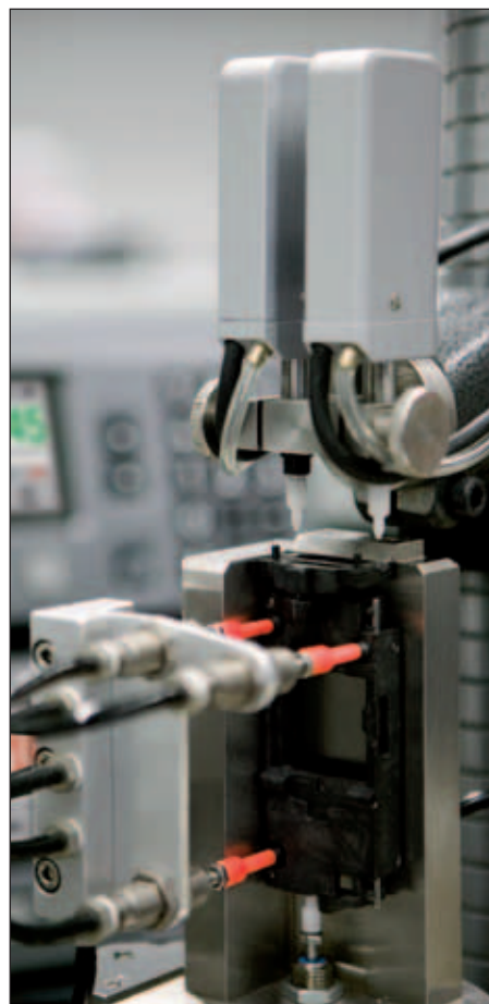
X-Y镜片安装工作台的位置测量
